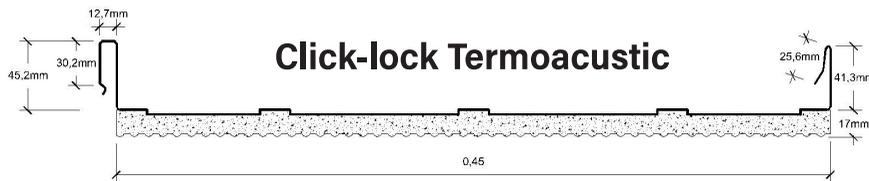
Aislamiento termo acústico en espuma de polietileno con espesores entre 5 y 15 milímetros
