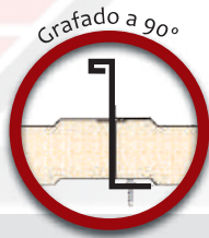
Láminas en acero galvanizado arriba y abajo calibre 28, 26 o 24 con o sin pintura poliéster al horno
